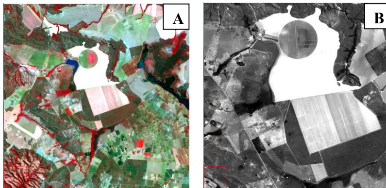
Figura 3. Imagem multiespectral (A) em composição colorida RGB 5/4/3 com 30 m de resolução espacial e imagem pancromática (B) com 15 metros.
